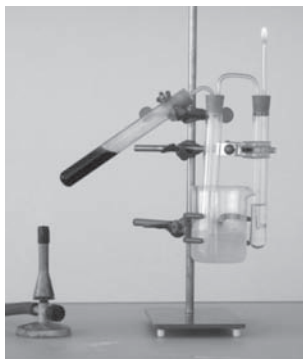
Après 4 minutes, on peut enflammer C_2H_4
