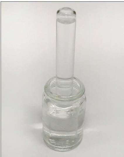
Abb. 3 Acetylen löst sich in Aceton
