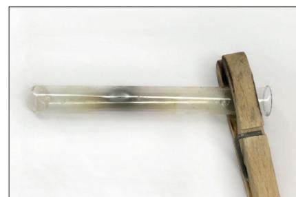
Abb. 2 Acetylen zersetzt sich beim Erhitzen
