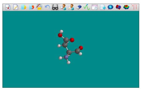
Abb. 3: Interface der Spartan-Applikation. Auf der oberen Leiste sind viele der wichtigsten Funktionen abgebildet. So können praktisch auf Knopfdruck die Molekülgeometrie optimiert, ein Molekularorbiltaldiagramm erstellt oder relevante IR-Frequenzen errechnet werden.
