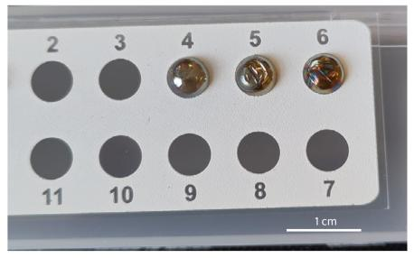
Abb. 2: Tollens-Reaktion auf dem Objektträger aus PTFE
